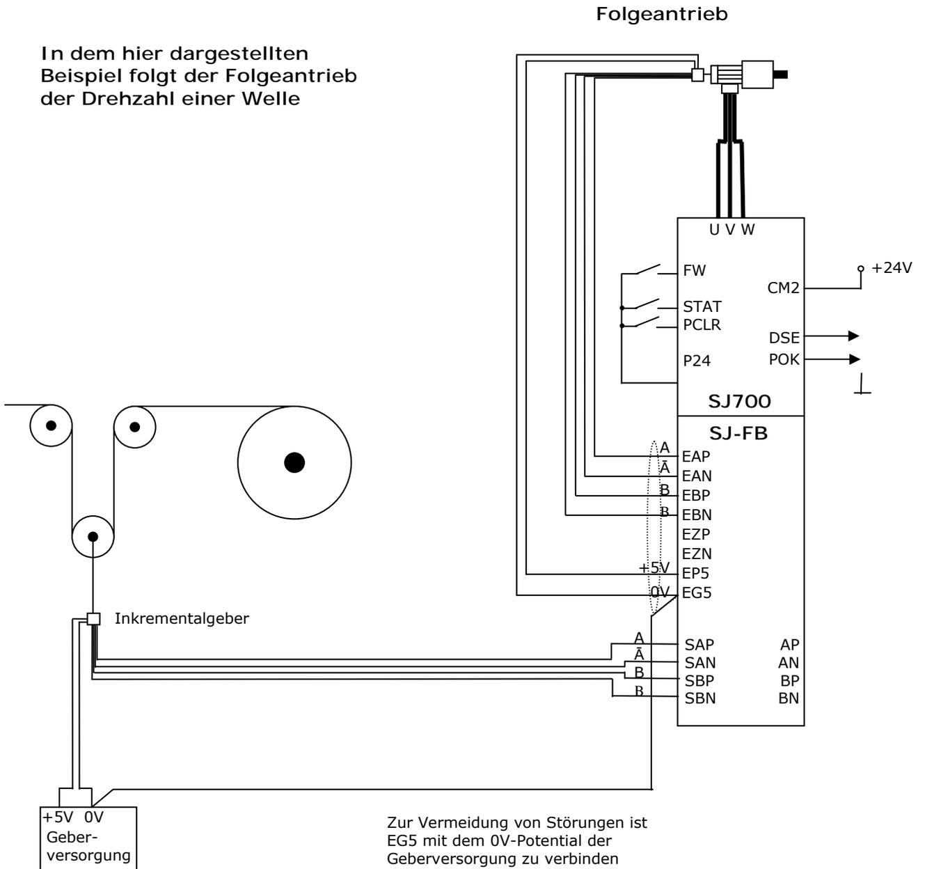
Anschlussbeispiel: Positionieren über Impulskettensignal
