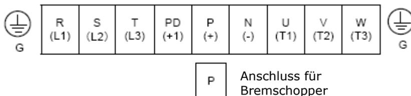
Anschlussart: Klemmleiste mit M16-Schrauben für L1, L2, L3, PD, P, N, U, V, W und M12-Schraube für PE; Anschluss Bremschopper (P): M8-Schraube
