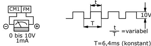
**Impulssignal für Frequenzmessgerät**
