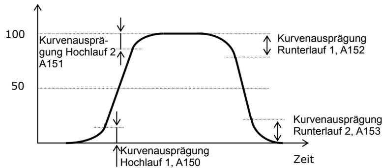
A150...A153=50%, Kurve entspricht der S-Kurve (A097/A098=03)
