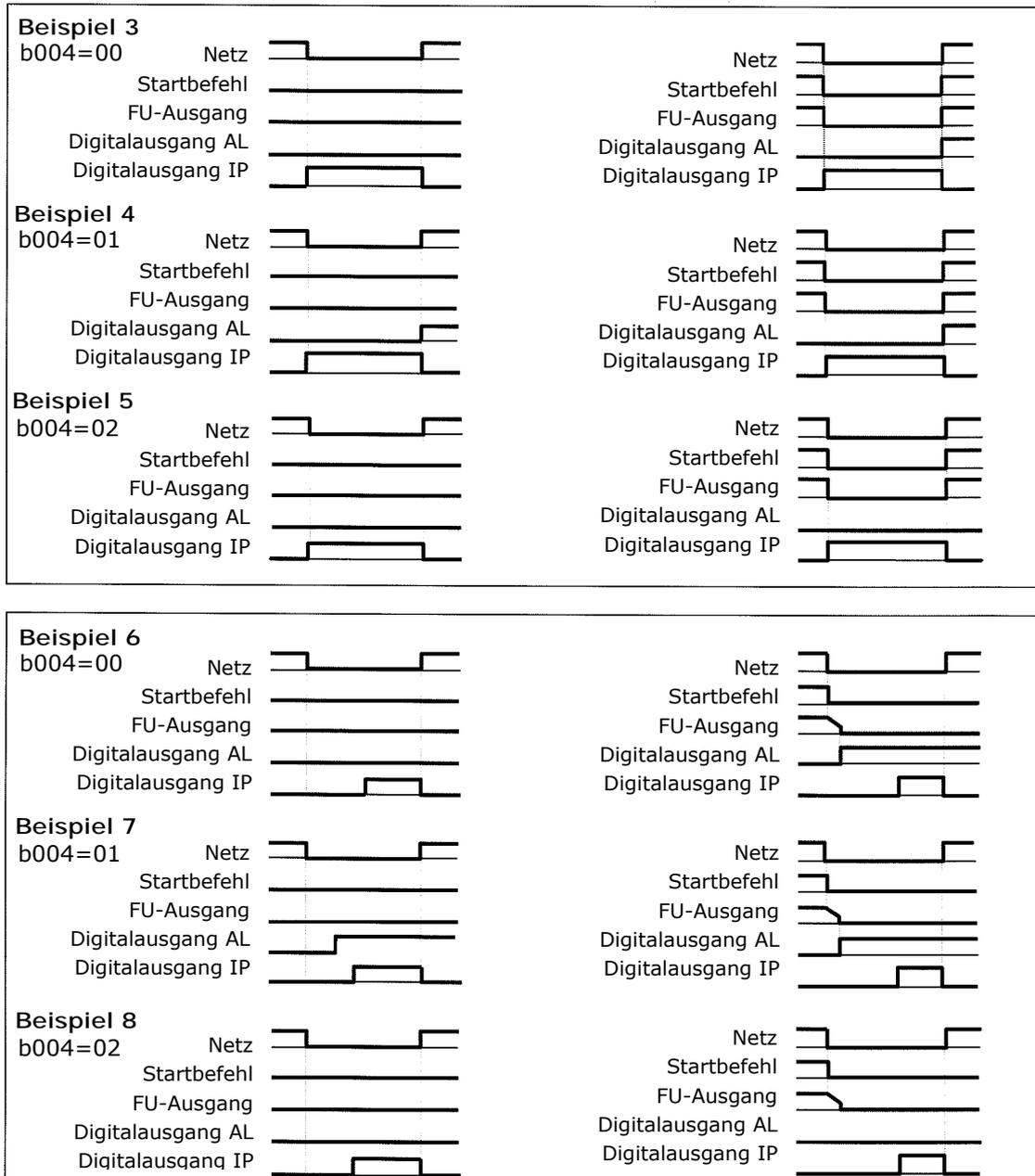
Programmierung der Digitalausgänge bzw. des Relais' erfolgt unter Funktion C021...C026.
