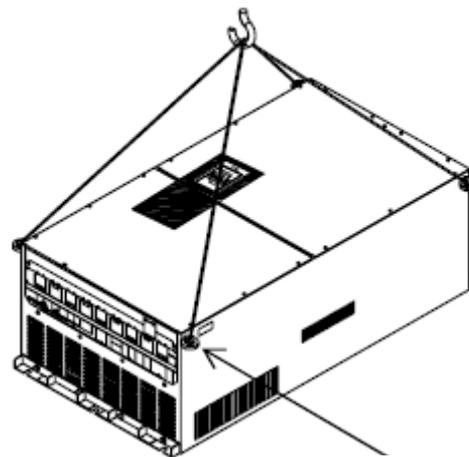
Transportöse an beiden Seiten eingeschraubt zum waagerechten Heben des Frequenzumrichters
