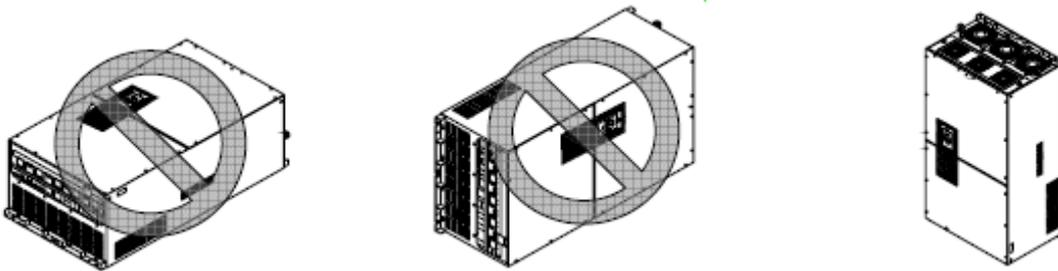
Aus Gründen der besseren Wärmekonvektion muss der Frequenzumrichter vertikal installiert werden. Installieren Sie das Gerät nicht in die Nähe wärmeabstrahlender Einrichtungen. Die Zwischenkreisdrossel sollte nicht unterhalb des Frequenzumrichters installiert werden.
