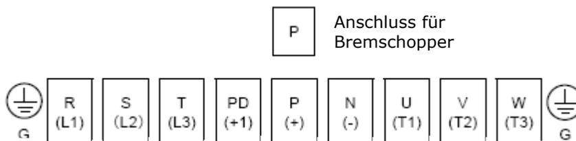
Anschlussart: Kupferschienen mit M12-Schrauben für L1, L2, L3, PD, P, N, U, V, W und M12-Schrauben für PE; Anschluss Bremschopper (P): M10-Schraube
