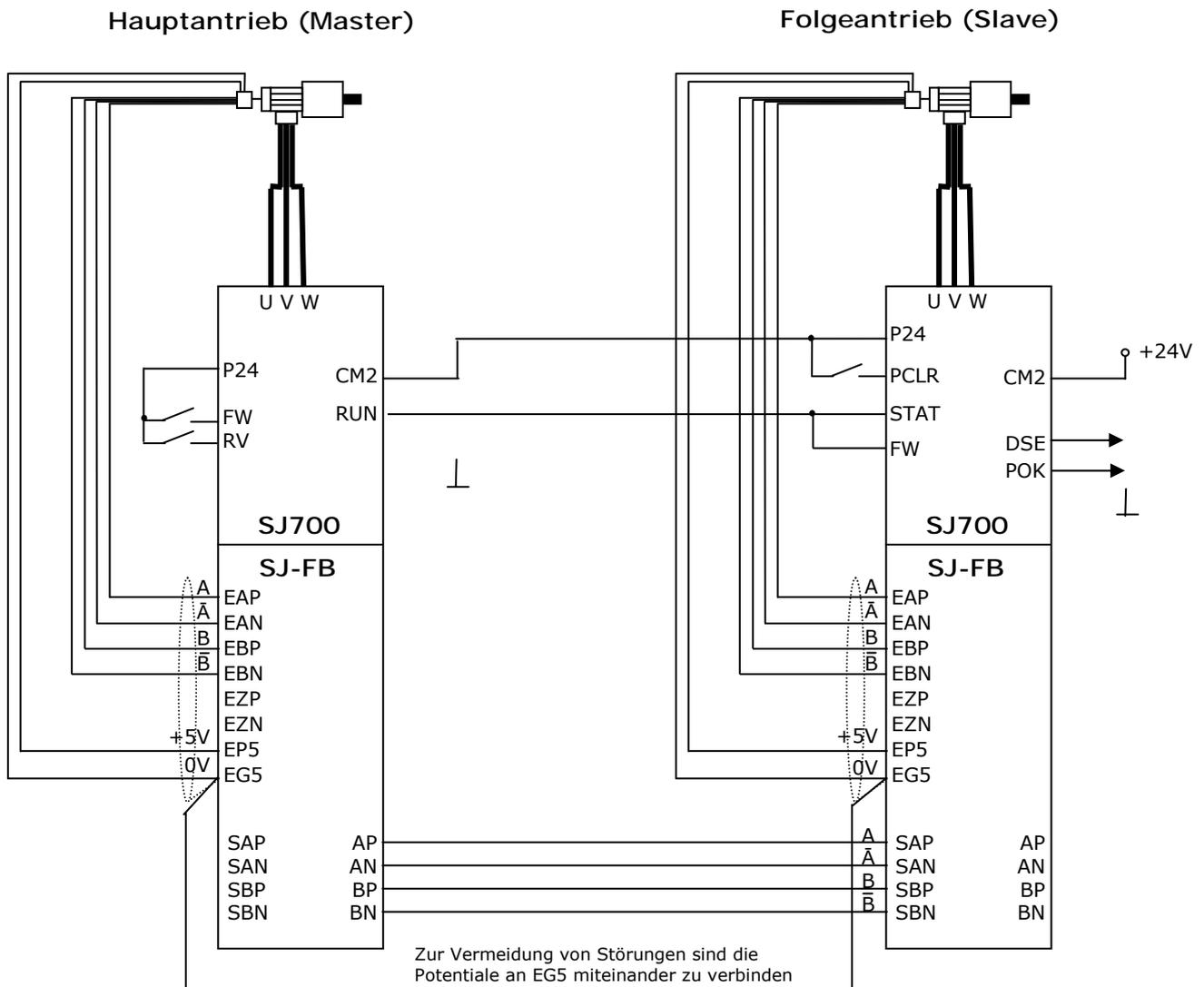
**Anschlussbeispiel: Elektrisches Getriebe mit Inkrementalgeber als Master**
