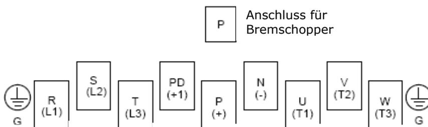
Anschlussart: Kupferschienen mit M16-Schrauben für L1, L2, L3, PD, P, N, U, V, W und M12-Schrauben für PE; Anschluss Bremschopper (P): M10-Schraube
