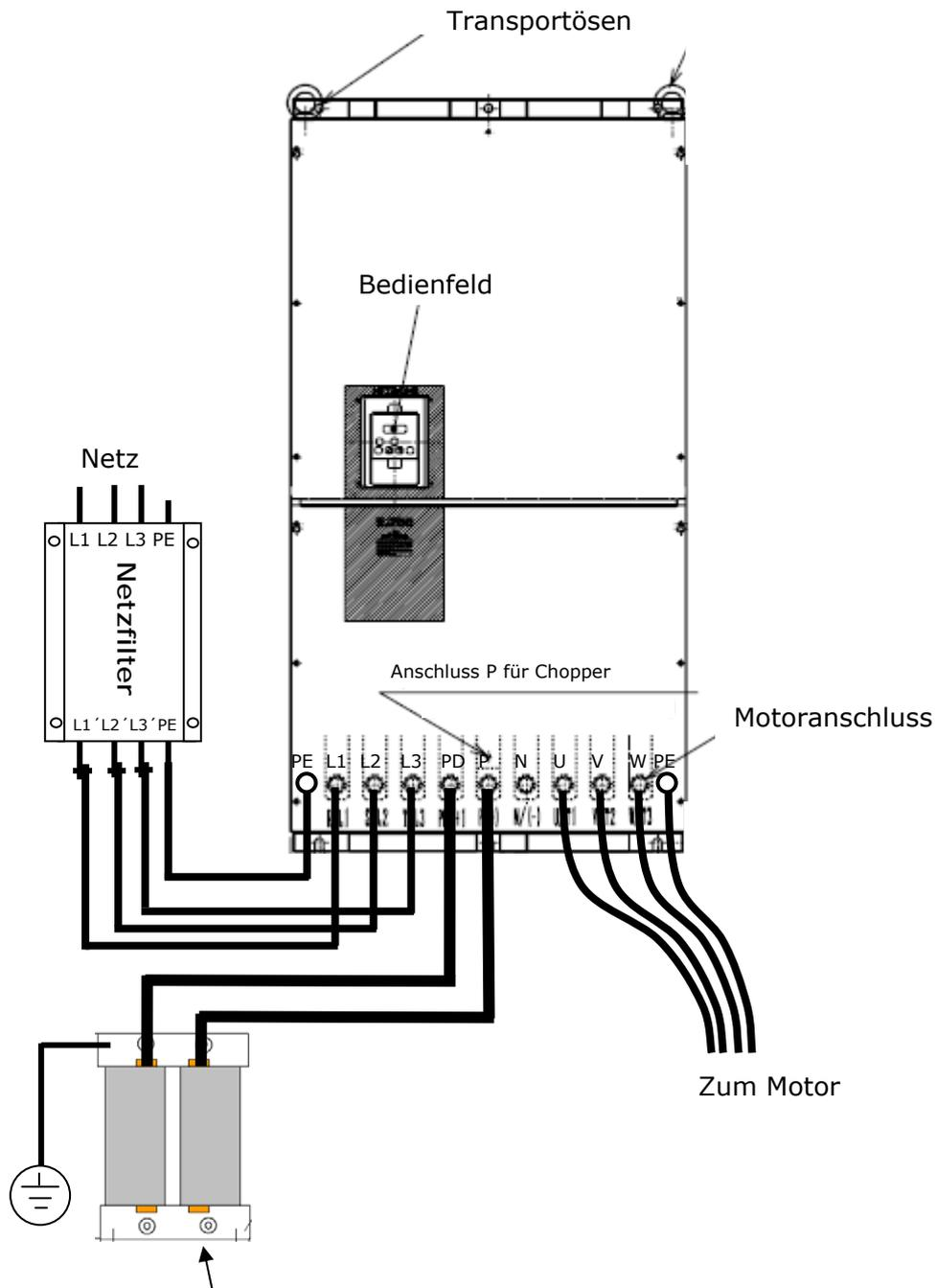
Zwischenkreisdrossel; Sollte eine Brücke zwischen PD und P installiert sein, so muss diese bei Anschluss einer Zwischenkreisdrossel entfernt werden. Für den Fall, dass keine Zwischenkreisdrossel verwendet wird, dann müssen die Anschlüsse PD und P miteinander verbunden werden. Bei der Auswahl des Leitungsquerschnitts richten Sie sich bitte nach den Angaben für die Zuleitung zu der Zwischenkreisdrossel.
