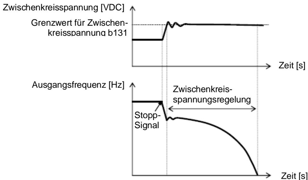
**b130=02:** Bei Überschreiten der in b131 eingestellten Zwischenkreisspannung wird die Frequenz gemäß Hochlaufzeit in b132 angehoben. Fällt die Zwischenkreisspannung wieder unter den Wert von b131, dann wird der Antrieb wieder verzögert.
