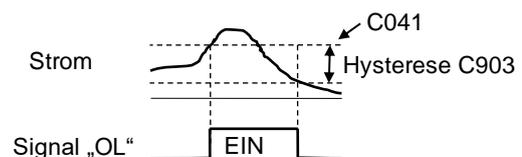
Einstellen der Reaktionszeit für diese Funktion erfolgt mit den Funktionen C901 und C902. Die Schalthysterese wird unter Funktion C903 eingestellt.
