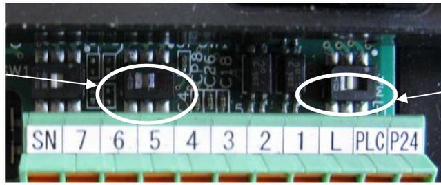
Der Schiebeschalter EDMSW1 dient zur Festlegung des Digitalausgangs 11 als Ausgang EDM „STO aktiv“. Er befindet sich über Klemme PLC.
