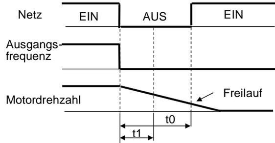
Die Netzausfallzeit ist länger als die unter b002 programmierte Zeit. Der Frequenzumrichter geht auf Störung
