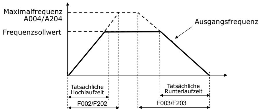
b091=01: bei Stopp wird nicht entsprechend der Runterlaufzeit abgebremst, sondern die Endstufen werden abgeschaltet und der Antrieb läuft unkontrolliert aus.
