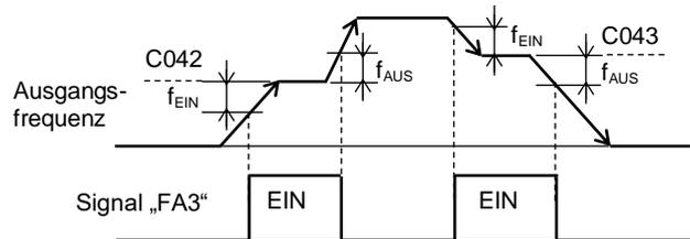
Hochlauf: Signal FA3 EIN bei 29,5Hz, Signal FA3 AUS bei 31Hz
