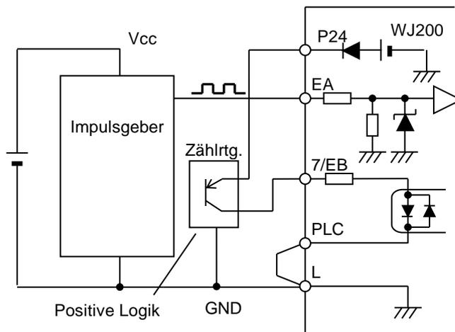
Geberspur an Klemme EA anschließen. Klemme 7 (Digitaleingang mit Funktion EB „Spur B für Inkrementalgeberanschluss“) kann in diesem Fall zur Änderung der Zählrichtung verwendet werden. Bei diesem Signal kann es sich sowohl um ein Signal mit positiver oder negativer Logik handeln. Ist der Digitaleingang angesteuert erfolgt die Zählrichtung in aufsteigender Richtung, ist er nicht angesteuert erfolgt die Zählrichtung in absteigender Richtung.
