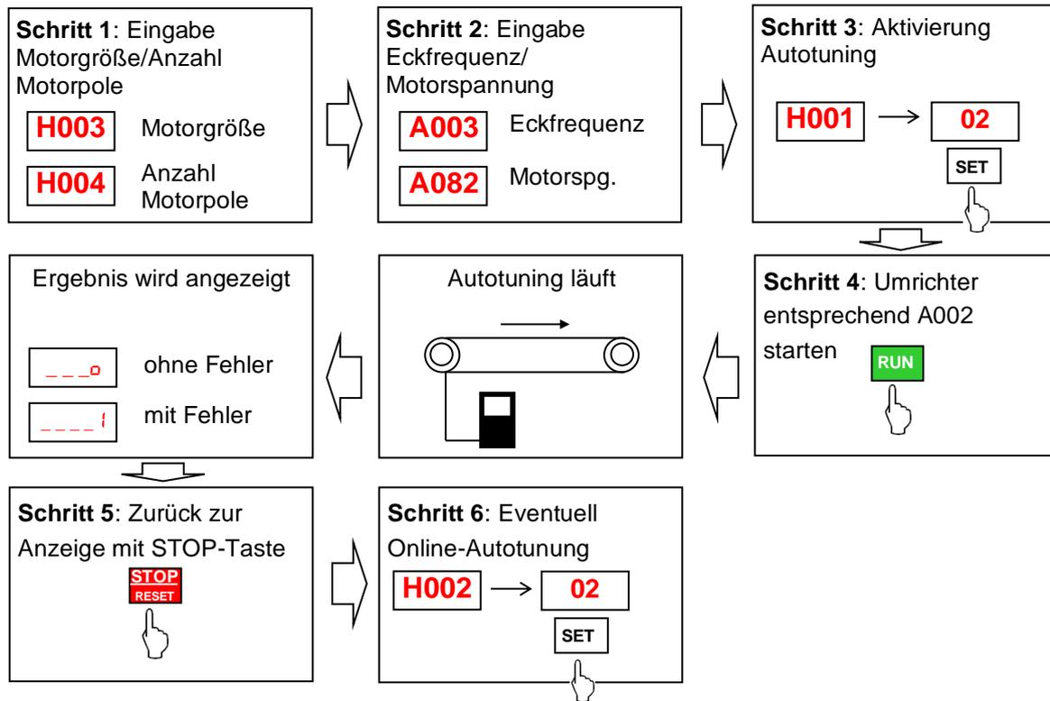
Alternativ zum dynamischen Autotuning kann **statisches Autotuning (H001=01)** durchgeführt werden. In diesem Fall dreht der Motor nicht (eine geringe Bewegung des Rotors kann durch Beaufschlagen mit Gleichspannung trotzdem auftreten).
