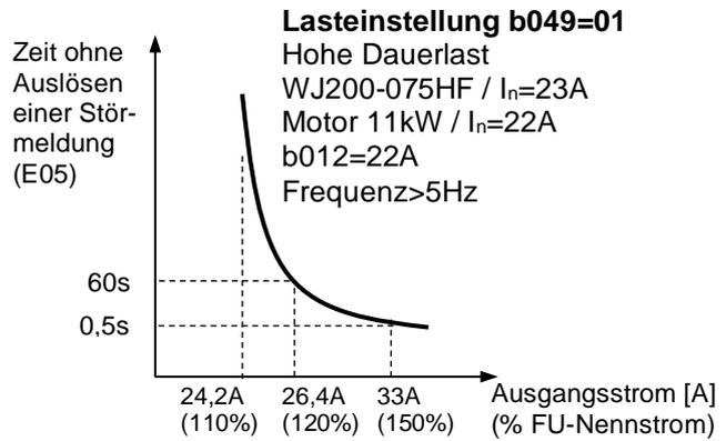
**Achtung!** Der Ausgangsstrom darf nicht dauerhaft über dem Frequenzumrichternennstrom liegt, da sonst die Lebensdauer der Zwischenkreiskondensatoren und Endstufen verringert wird.
