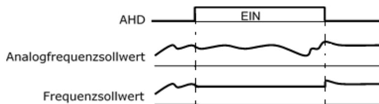
Bei AHD=EIN wird der Sollwert auch bei Netz-Aus/Netz-Ein oder Umschalten des Parametersatzes mit Digitaleingang SET gehalten. **Achtung!** Bei häufiger Verwendung dieser Funktion kann das EEPROM zerstört werden.
