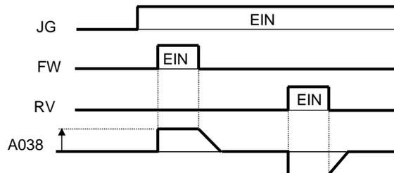
Der Tipp-Betrieb ist nicht möglich, wenn die eingestellte Tipp-Frequenz kleiner ist als die unter b082 eingegebene Startfrequenz.
