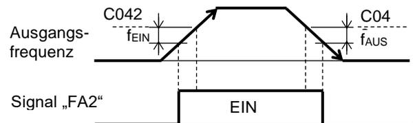
Dieses Signal kann zum Ansteuern einer Motorbremse verwendet werden.
