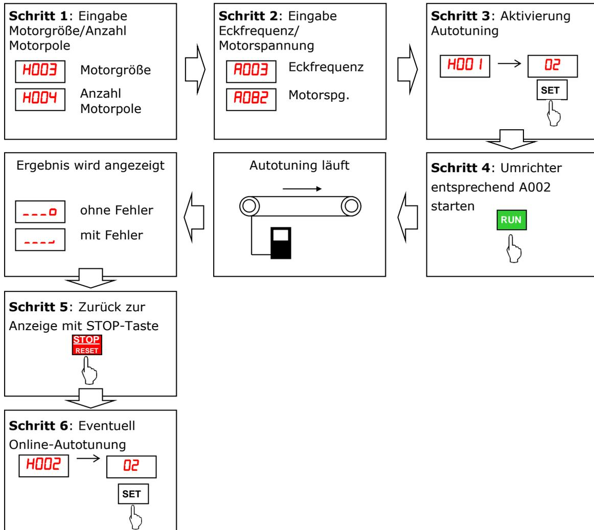
Alternativ zum dynamischen Autotuning kann **statisches Autotuning (H001=01)** durchgeführt werden. In diesem Fall wird der Motor nicht drehen (eine geringe Bewegung des Rotors kann durch Beaufschlagen mit Gleichspannung trotzdem auftreten).
