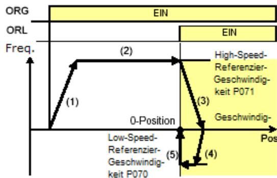
Nach Abschluss der Referenzierung wird die aktuelle Position als 0-Position festgelegt. Sollte keine Referenzierung durchgeführt werden so wird die Netz-Ein-Position als 0-Position festgelegt. Ein Start-Befehl FW bzw. RV ist zur Auslösung der Referenzierung nicht erforderlich. Nach Erreichen des Referenzschalters wird der Motor gestoppt und die Gleichstrombremsung ist aktiv. Nach Wegnahme des Signals für die Referenzierung (ORG) wird diese ausgeschaltet.
