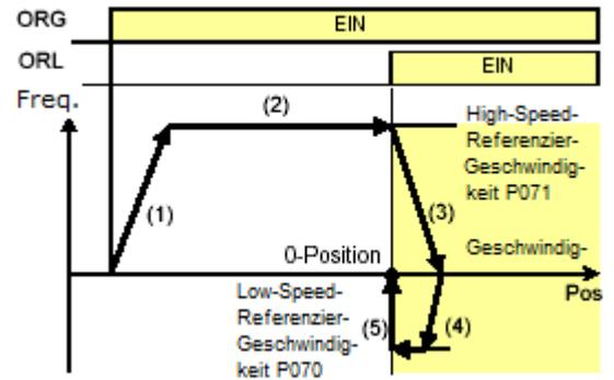
**Bremsensteuerung und Positionierung**
