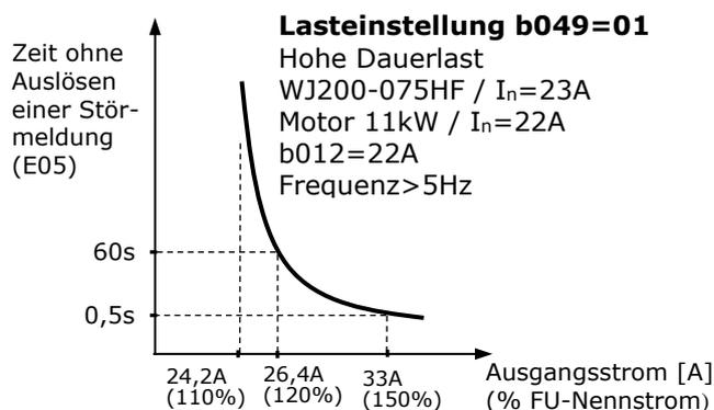
**Achtung!** Achten Sie darauf, dass der Ausgangsstrom nicht dauerhaft über dem Frequenzumrichternennstrom liegt da sonst die Lebensdauer der Zwischenkreiskondensatoren und Endstufen verringert wird.
