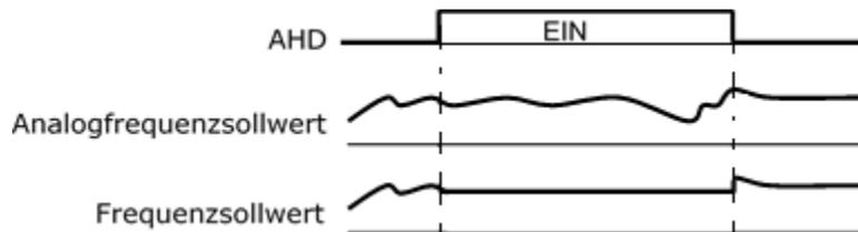
Bei AHD=EIN wird der Sollwert auch bei Netz-Aus/Netz-Ein oder Umschalten des Parametersatzes mit Digitaleingang SET gehalten.
