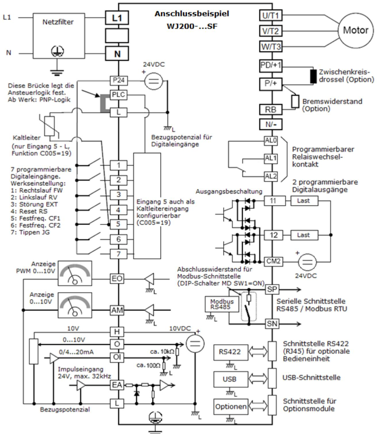
Die Versorgung des Steuerteils kann über eine externe 24VDC-Spannungsquelle erfolgen. In diesem Fall muss eine Diode wie unten dargestellt installiert werden.
