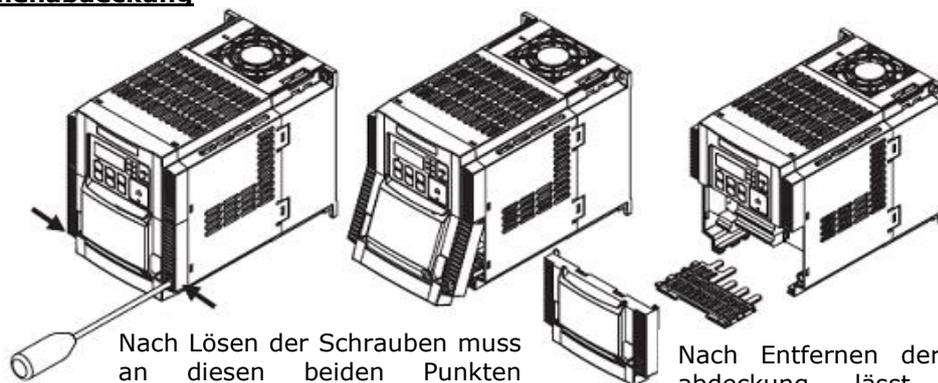
Nach Lösen der Schrauben muss an diesen beiden Punkten gedrückt und die Abdeckung angehoben werden.
