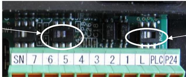
Der Schiebeschalter EDMSW1 dient zur Festlegung des Digitalausgangs 11 als Ausgang EDM „STO aktiv“. Er befindet sich über Klemme PLC.
