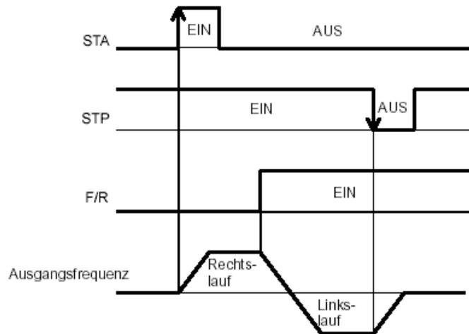
Ist STP als Öffner programmiert, so kann auch der Stop mittels EIN-Impuls ausgelöst werden. Die Eingänge FW und RV sind nicht aktiv wenn einer der Eingänge als STP programmiert ist. Ist bei Netz-Ein der Eingang STA=EIN ist, dann wird ein Start ausgeführt.
