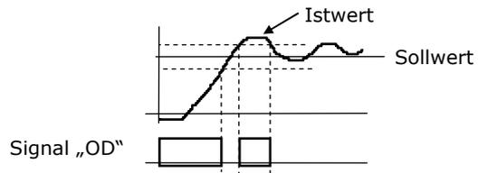
Digitalausgang / Relais AL0-AL1 „OD“ schaltet wenn die unter C052 / C053 programmierte Regelabweichung überschritten wird (C021...C026=04).
