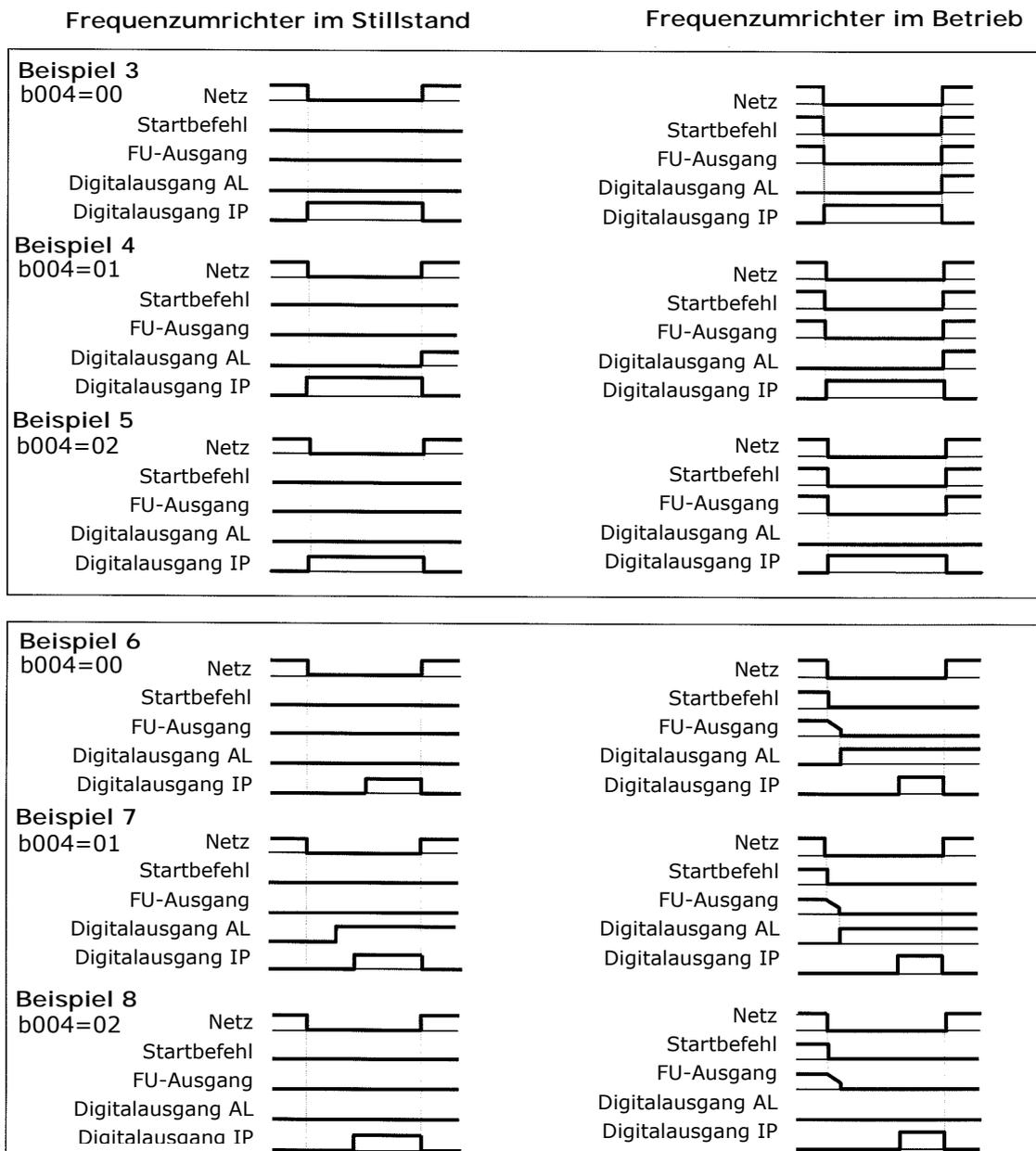
Programmierung der Digitalausgänge bzw. des Relais' erfolgt unter Funktion C021...C026.
