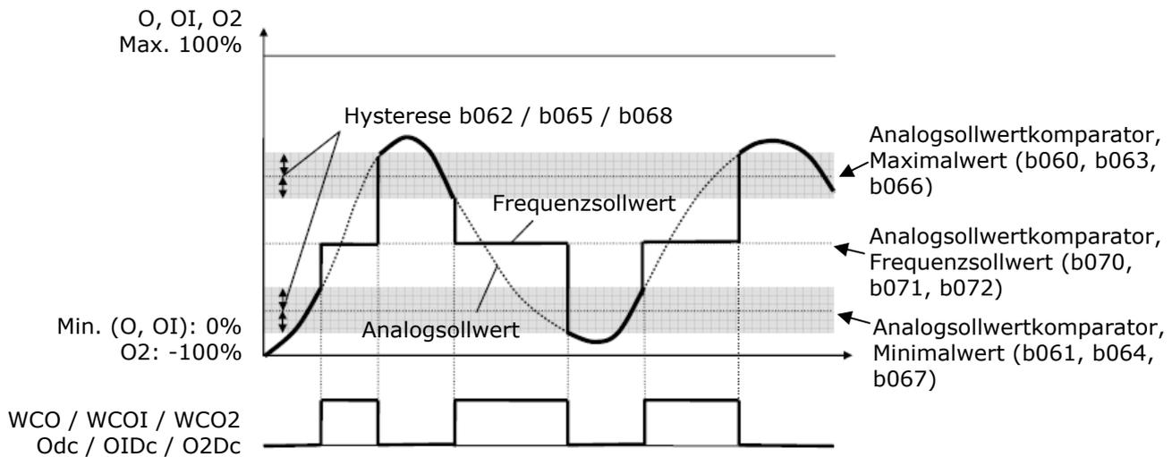
**Beispiel 1:** Bei Analog Sollwerten <0,5V an Analogeingang O soll Ausgang ODc gesetzt werden. In diesem Fall soll der Umrichter mit 40Hz fahren. Voraussetzung: A004=50Hz
