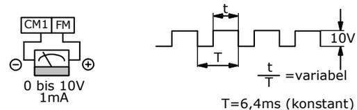
**Impulssignal für Frequenzmessgerät**
