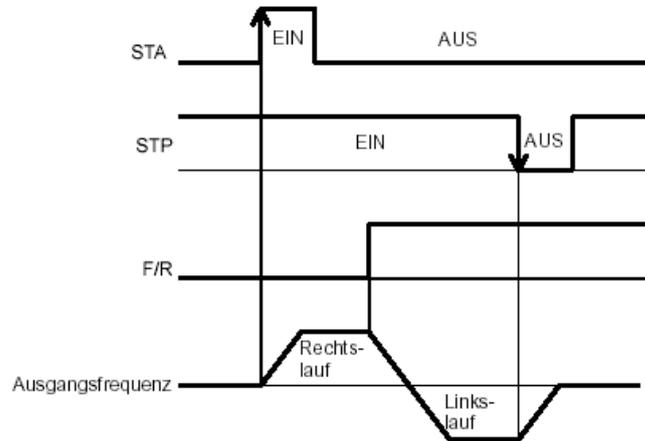
Ist STP als Öffner programmiert, so kann auch der Stop mittels EIN-Impuls ausgelöst werden. Die Eingänge FW und RV sind nicht aktiv wenn einer der Eingänge als STP programmiert ist.
