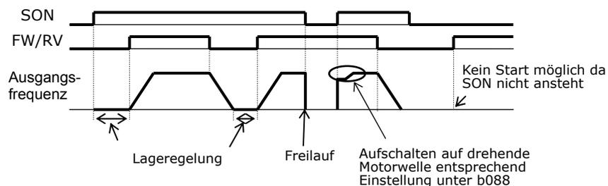
Wird die Reglersperre bei laufendem Motor geschaltet, so wird der Motor sofort gestoppt. Hierbei kann es zur Auslösung einer Störmeldung „Überstrom“ kommen.
