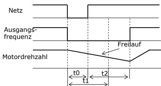
Die Netzausfallzeit ist kürzer als die unter b002 programmierte Zeit. Nach Ablauf von t2, Synchronisierung auf die Motordrehzahl und Hochlauf auf die Motordrehzahl
