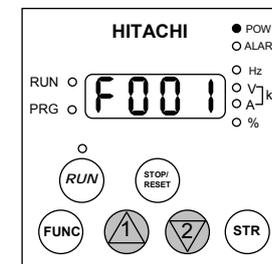
Unabhängig der Display-Anzeige wird nach 3s Drücken der Taste FUNC automatisch die Istfrequenz unter d001 angezeigt.
