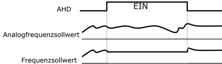
Bei AHD=EIN wird der Sollwert auch bei Netz-Aus/Netz-Ein oder Umschalten des Parametersatzes mit Digitaleingang SET / SET3 gehalten.
