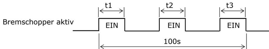
$$\text{Einschaltdauer ED (\%)} = \frac{t_1+t_2+t_3}{100\text{s}} \times 100$$
