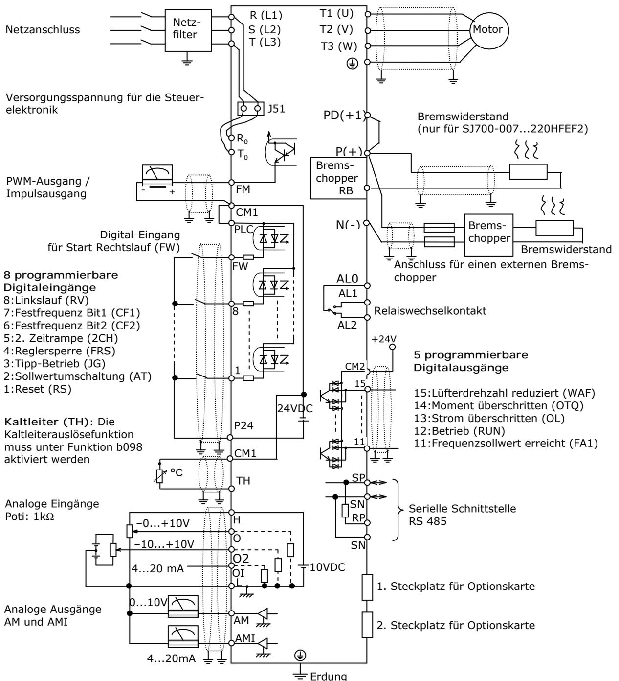
Die Steuerleitungen sind getrennt von den Netz- und Motorleitungen zu verlegen. Sie sollten eine Länge von 20m nicht überschreiten und müssen abgeschirmt verlegt werden. Bei längeren Leitungslängen empfehlen wir Signalverstärker. Kreuzungen zwischen Netz- bzw. Motorleitungen und Steuerleitungen sollten - wenn nicht zu vermeiden - rechtwinkelig verlegt werden.
