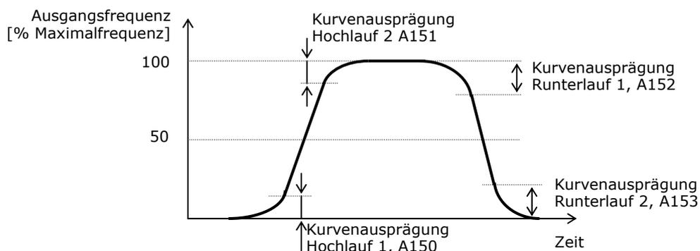
A150...A153=50%, Kurve entspricht der S-Kurve (A097/A098=03)
