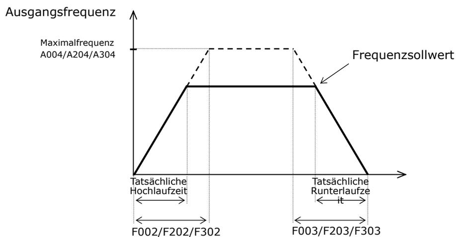
b091=01: bei Stop wird nicht entsprechend der Runterlaufzeit abgebremst sondern die Endstufen werden abgeschaltet und der Antrieb läuft unkontrolliert aus.
