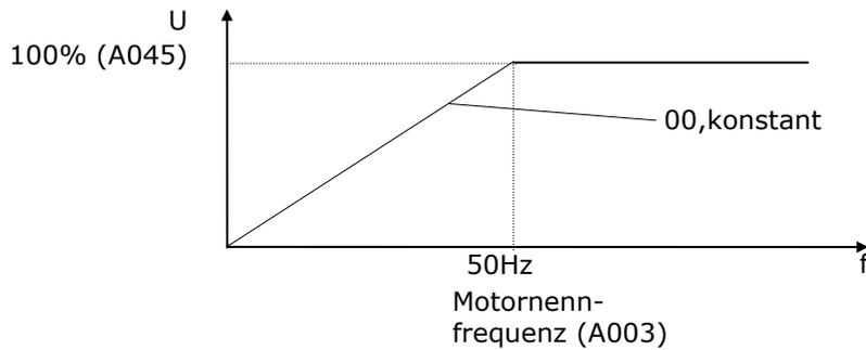
Optimierungen wie Drehmomentanhebung und Schlupfkompensation erfolgen unter Funktion A041...A047.
