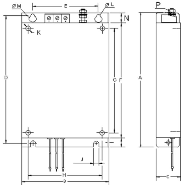
Abmessungen Nebenbaufilter [mm]
