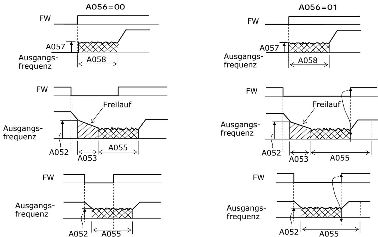
A051=02: Aktivierung der DC-Bremse wenn Frequenzsollwert=Ausgangsfrequenz < A052 und ein Startbefehl anliegt (Beispiel 1). Abschalten der DC-Bremse erfolgt wenn die Ausgangsfrequenz den Frequenzwert unter A052 um mehr als 2Hz überschreitet (Beispiel 2).
