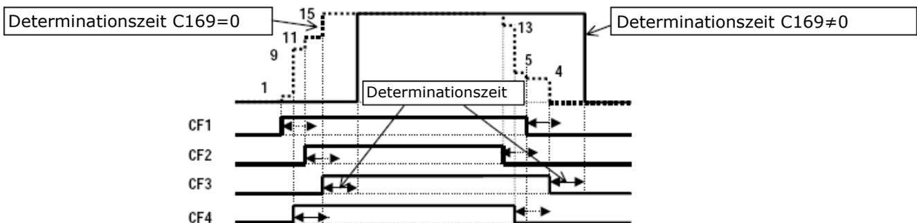
2. Abrufen von bis zu 7 Festfrequenzen (A21...A27) bitweise über die Digital-Eingänge SF1...SF7 (C001...C008=32...38, A019=01). Beim Ansteuern von 2 oder mehr Festfrequenzen gleichzeitig hat die Frequenz mit der niedrigsten Ordnungszahl Priorität.
