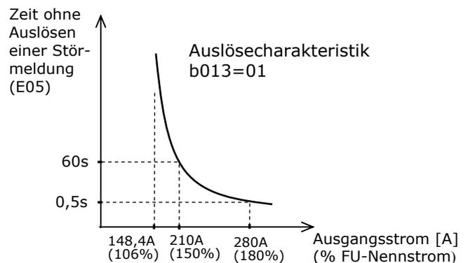
**Achtung!** Achten Sie darauf, daß der Ausgangsstrom nicht dauerhaft über dem Frequenzumrichterennstrom liegt da sonst die Lebensdauer der Zwischenkreiskondensatoren und Endstufen verringert wird.
