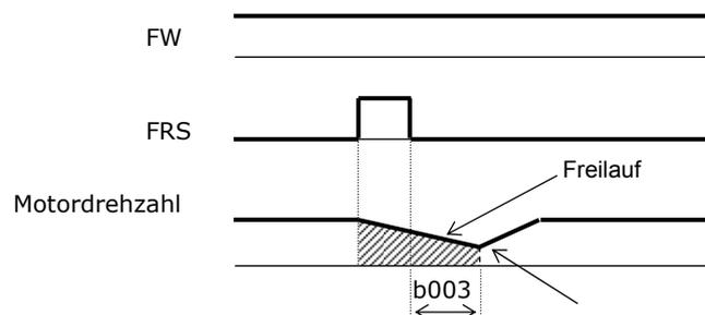
**b088=02:** Synchronisieren auf die Motordrehzahl nach Ablauf der unter Funktion b003 programmierten Wartezeit durch aktives Erfassen der Motordrehzahl. Da dieses Verfahren unabhängig von der Motorinduktionsspannung arbeitet kann es auch dann angewendet werden wenn der Motor sehr lange spannungsfrei gewesen ist.
